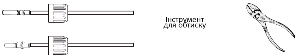
Рис. 3.4 Закріплення контактної штифту на дрiт
